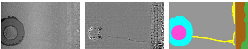
Abbildung 4: Dargestellt sind v. l. n. r. Ausschnitte von Oberflächenmodellen des PPS auf Basis der Reflexionsintensität und der lokalen Höhenvarianz sowie die zugehörige Label-Maske.
