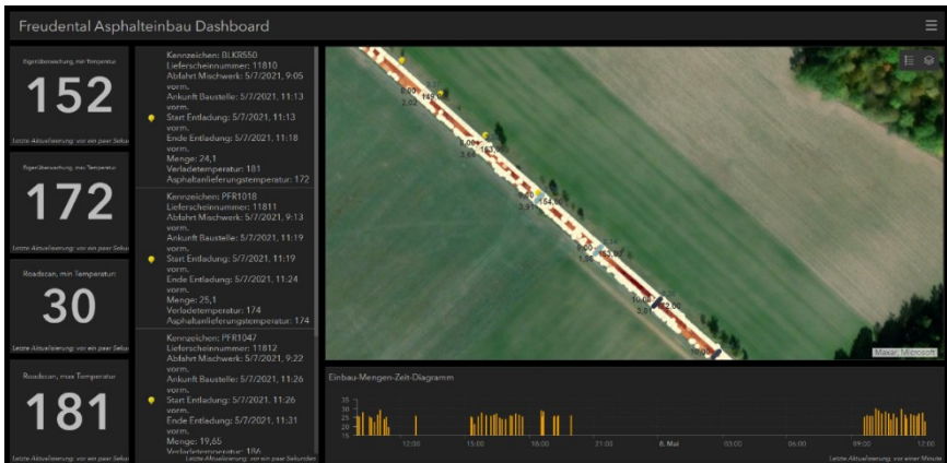
Abbildung 2: Dashboard mit Datenübersicht zum Asphaltteinbau des VIA IMC
