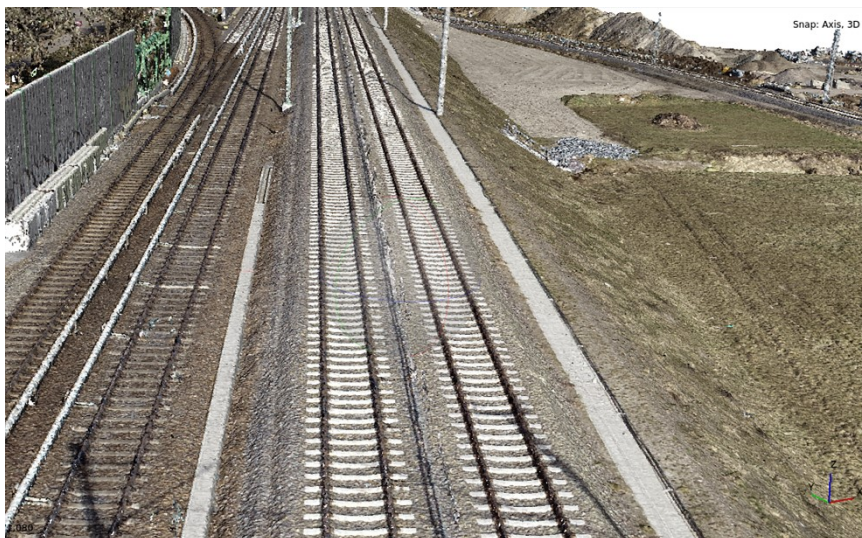
Abbildung 2: Punktwolke als Ergebnis einer Drohnenbefliegung am Berliner Nordkreuz
