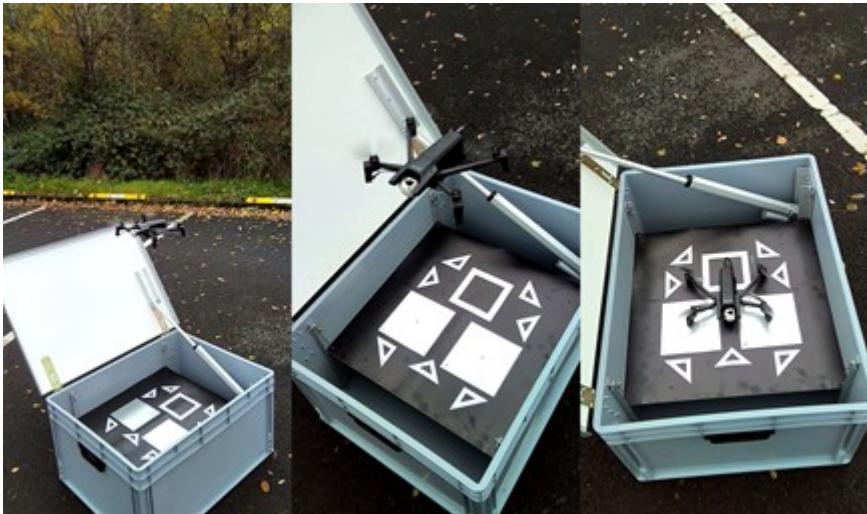
Abbildung 1: Verschiedene Phasen des Landeanflugs der Drohne in die Box
