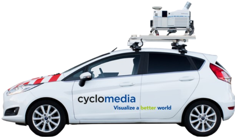
Abbildung 2: Aufnahmefahrzeug von Cyclomedia inklusive des patentierten Erfassungssystems
