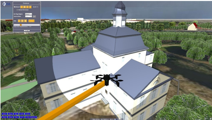
Abbildung 2: Simulation des Drohnenfluges einschließlich Ausrichtung/Neigung der Kamera
