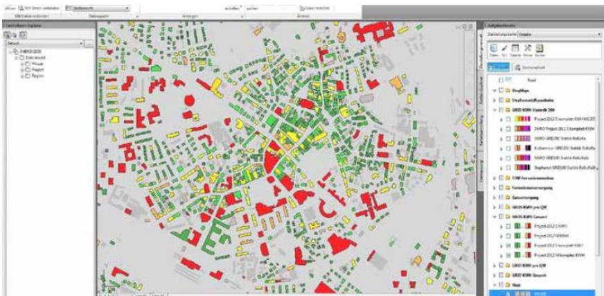
Abbildung 2: Die Fachanwendung visualisiert den Gesamtwärmebedarf von Gebäuden. Daneben lassen sich auch Zukunftsszenarien entwickeln.
