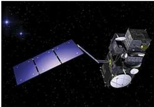
Sentinel 3 (optische Sensoren, Radiometer, Radar Altimeter)
