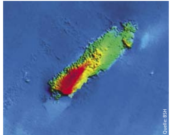
Fächerecholotaufnahme eines Wracks auf dem Grund der Kadetrinne
