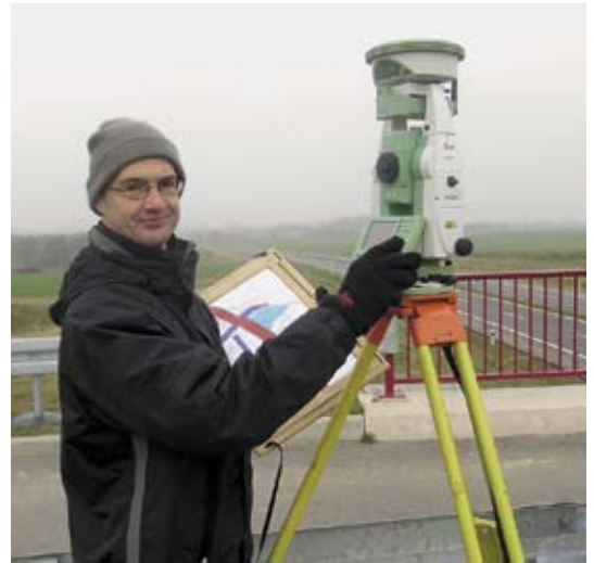
Smartstation – Tachymeter mit aufgesetzter GPS-Antenne/-Sensor und Funkmodem zum Empfang der SAPOS®-Korrekturdaten
