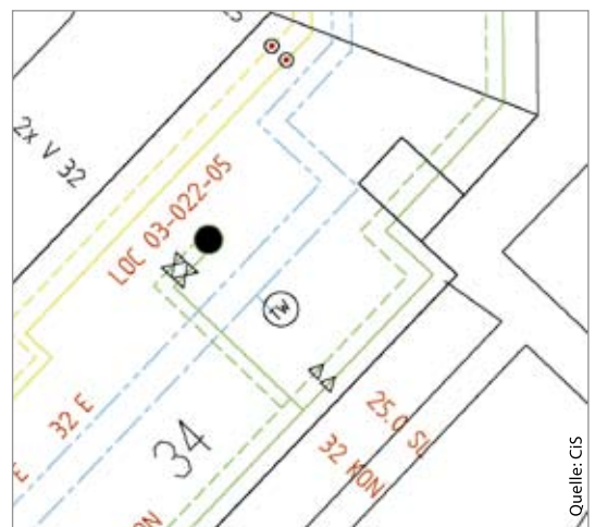
Ermittlung von Absperrbereichen (Fernwärme)
