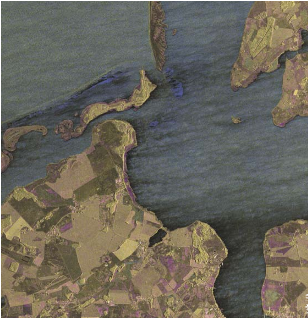
Die dargestellten Farben in dem TerraSAR-X Radarbild des Kubitzer Boddens nördlich von Stralsund geben darüber Auskunft, wie stark die Erdoberfläche die ausgesendeten Radarstrahlen in den verschiedenen Polarisationen zurückstreut (Rot: HH, Grün VV, Blau: HH-VV). Hieraus können Rückschlüsse über verschiedene Eigenschaften der rückstreuenden Flächen gezogen werden (z.B. Rauigkeit und Feuchte), Aufnahmedatum: 7. Juli 2007, Originalauflösung: 3 Meter.
