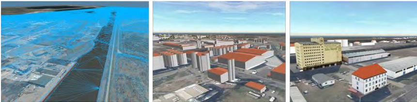
**Abbildung 2: Geländemodell mit 3D-Geometriekanten (links); 3D-Gebäudemodelle mit LoD 2 (Mitte); texturierte Gebäudemodelle (rechts)**
