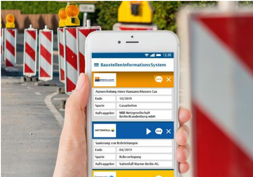
Abbildung 2: Nach dem Einscannen einer DIN-genormten Baustellenbake werden dem Nutzer der BIS-App die Baustellendaten angezeigt.
