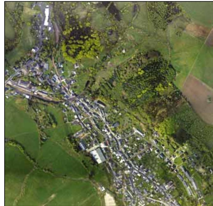
Bodenauflösung 9 cm bei einer Flughöhe von 500 m (Schwadbreite 730 m).
