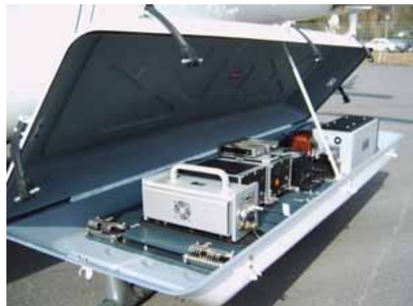
Abl. 3: Helikoptergestützte LIDAR inkl. Systemintegration, Abl.4: Eurocopter AS 350, Laserscansystemen sowie RGB-Digital-Framekamera & INS
